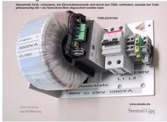
**Bild 2:** TSRL-platine für bis zu 500V und bis zu 32Aeff.
