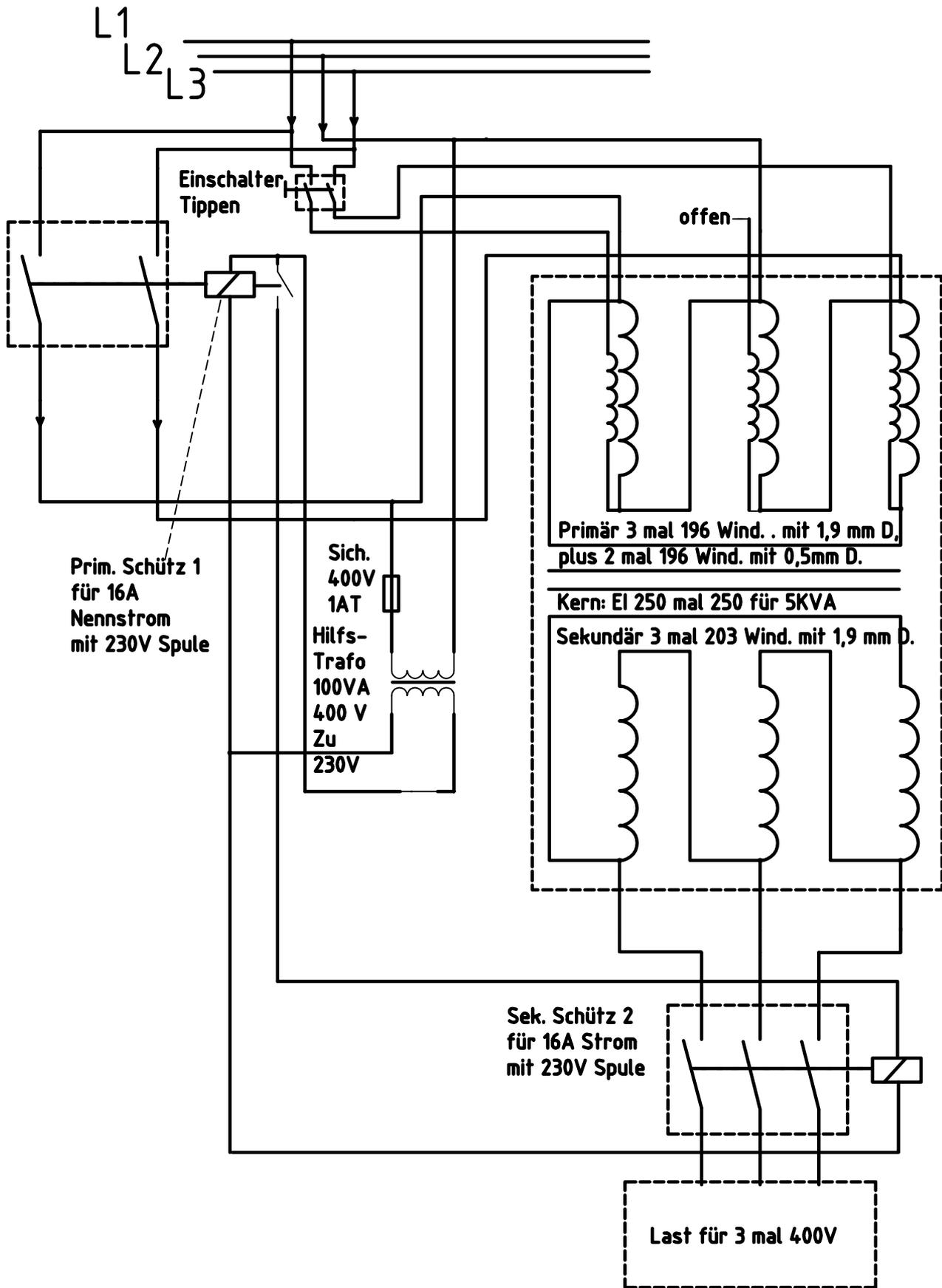
Drehstromtrafo mit 2 Hilfswicklungen in Dd0, 5kVA, ohne Einschaltstrom
